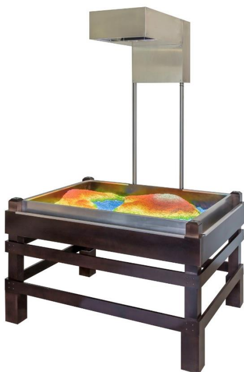
Figura 2.2.3: Una caja de arena de Realidad Aumentada (Fuente: https://www.topobox.co/order ).
