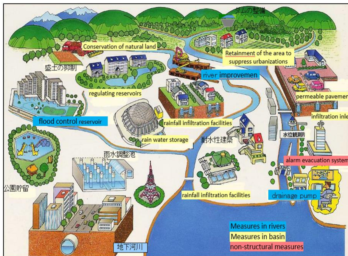
Fig.12.1: Imagen esquemática de las medidas globales del control de inundaciones (Ikeuchi, 2019)
